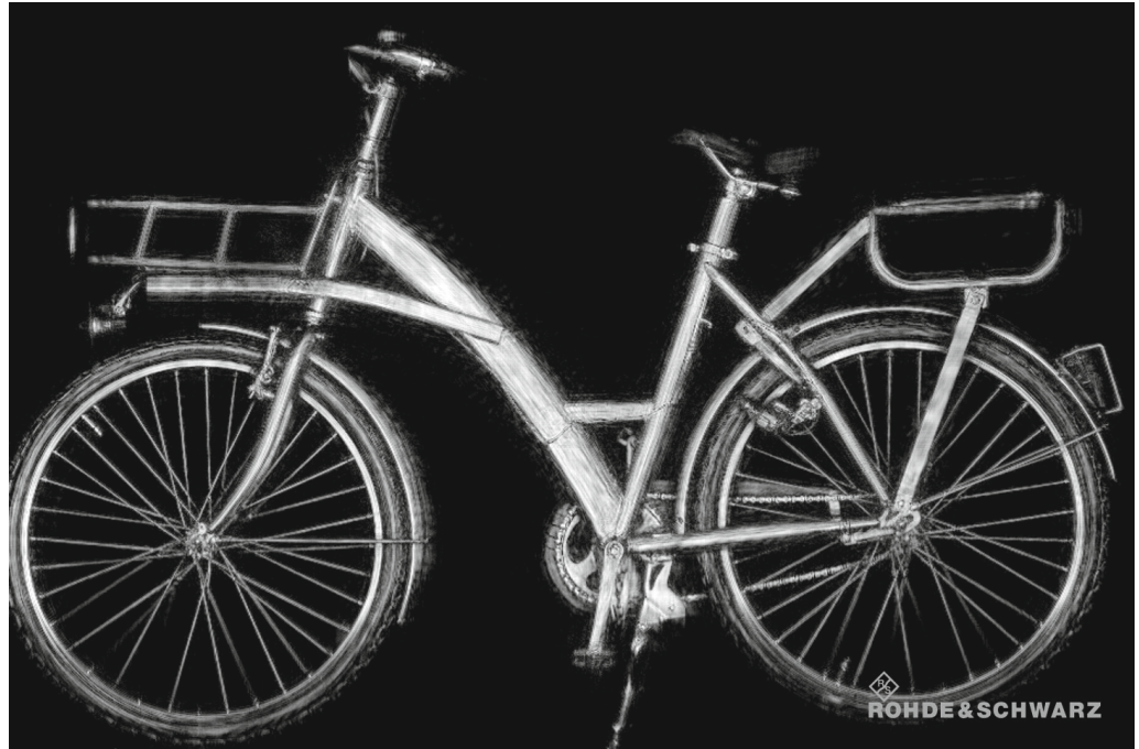
그림 10: mmWave Rohde & Schwarz가 촬영 한 사진, 주파수 70 GHz ~ 80 GHz, 수천 개의 송수신 안테나
