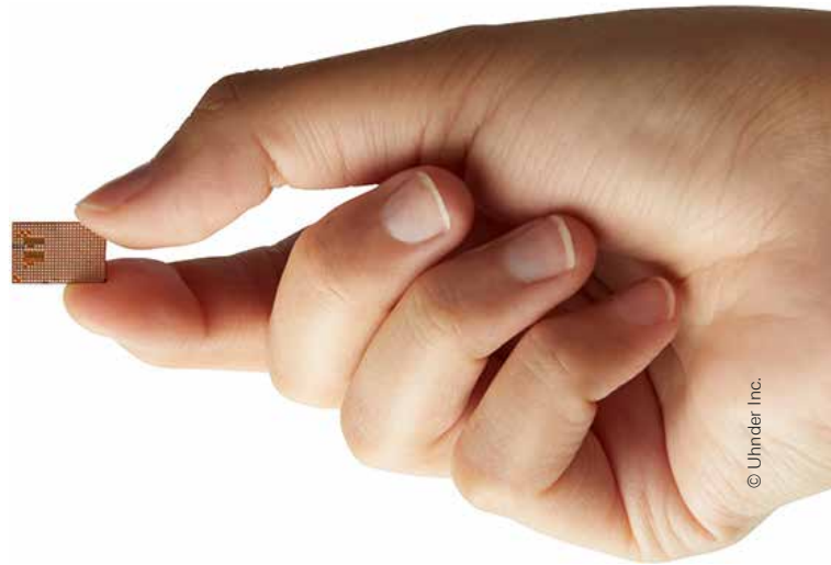
그림 4: 이 작은 칩은 모든 신호 처리 회로를 갖춘 완전한 다중 채널 레이더라고는 믿기 어렵습니다. 빠진 것은 안테나뿐입니다.
