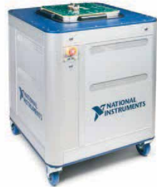
STS T4 시스템 최대 4개의 18 슬롯 PXI 새시 탑재 가능
