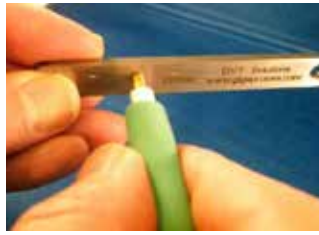
그림 3. Signal-Signal Pitch Calibration: Model 10 SMA 고정 렌치로 빈번히 사용하는 0.8 mm, 1.0 mm, 1.27 mm 간격을 조정. 프로빙 위치를 조정하고 이외의 다양한 간격을 정밀하게 조정하기 위해서는 기본 포함된 트위저와 탁상용 확대경 사용
