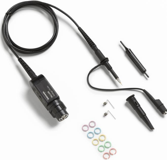
P6139B 및 P5050B 프로브는 입력 저항이 10MΩ 인 고대역, 고임피던스 10X 패시브 전압 프로브입니다. 이러한 프로브는 작은 프로브 헤드와 팁이 뾰족해 조밀한 회로를 더 손쉽게 탐침할 수 있습니다. P6139B 와 P5050B 는 전기 사양이 유사하지만 보정 범위가 각기 다른 텍트론릭스 오실로스코프를 지원합니다. [www.tektronix.co.kr/probes](http://www.tektronix.co.kr/probes) 에 위치한 오실로스코프 프로브 및 액세서리 선택 도구를 참조해 사용 중인 오실로스코프에 적합한 프로브를 찾으십시오.
